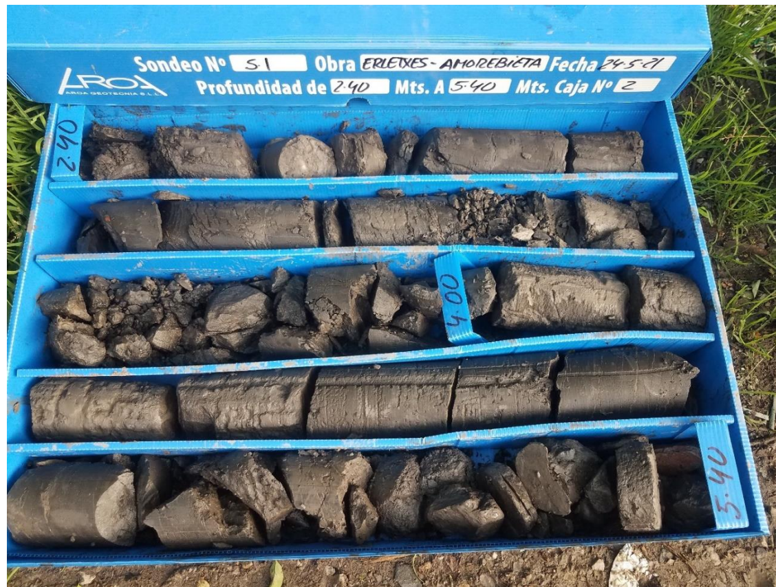
Figura nº6. Aspecto de una zona lutítica
